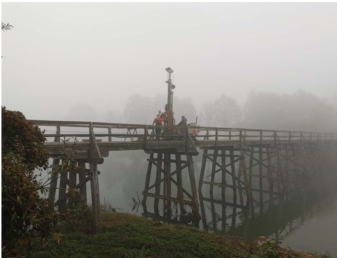
Slika 1: Izvajanje vrtalnih del in PMT meritev na mostu čez Krko v Borštu (VIR: IRGO consulting d.o.o.)
